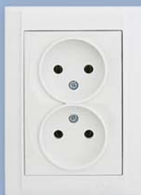
42001017 Розетка 2-я без заземления Напряжение 250V Сила тока 16A Степень защиты IP20
