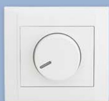
42001093 Диммер Макс. мощность 1000W Мин. мощность 60W Сила тока 5A Степень защиты IP20
