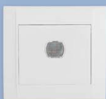
42001045 Диммер с дистанционным управлением Макс. мощность 400W Мин. мощность 60W Сила тока 4A Степень защиты IP20
